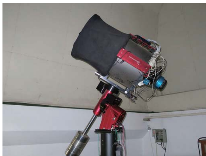
紫金山天文台盱眙觀測站 0.4 米口徑望遠鏡 0.4m aperture telescope for Xuyi station of Purple Mountain Observatory.
