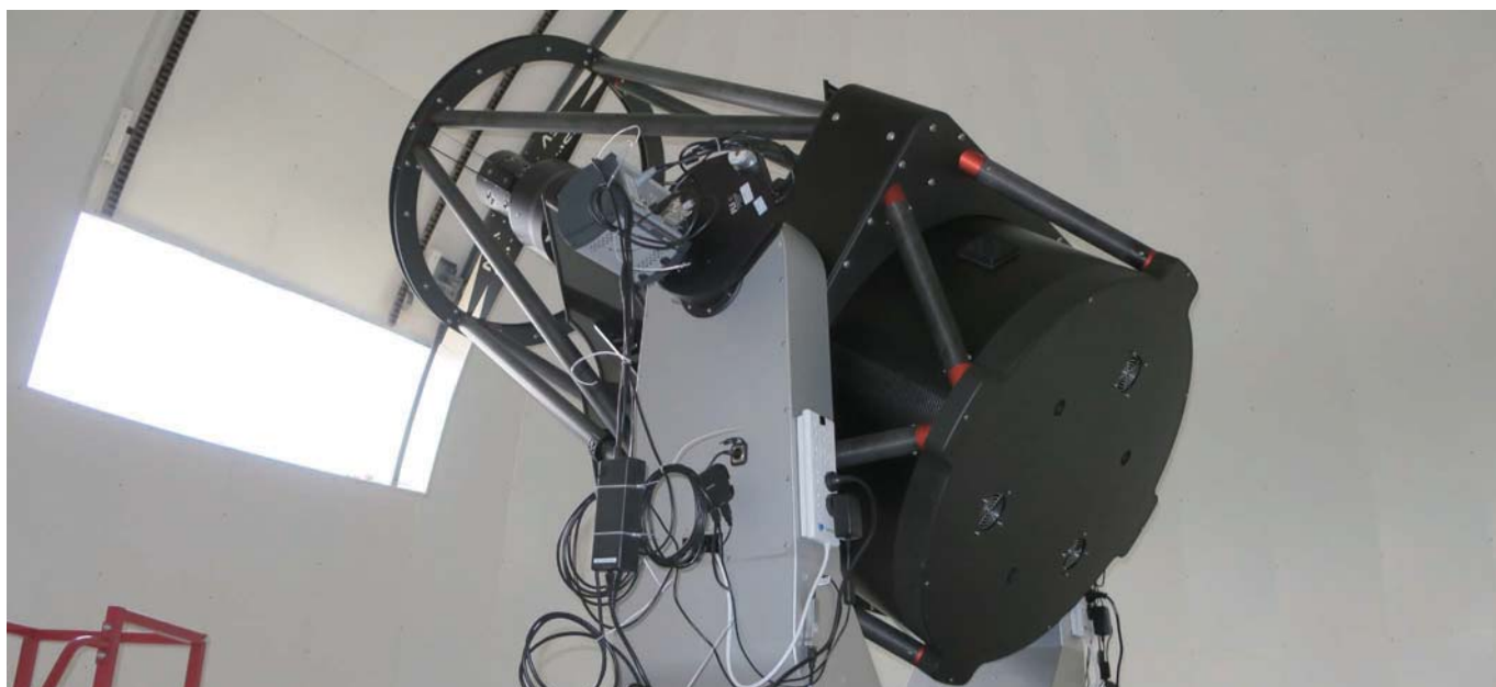
為紫金山天文台雲南基地建造的 0.8 米口徑 f/10 RC 望遠鏡 0.8m f/10 RC telescope built for Yunnan station of Purple Mountain Observatory
