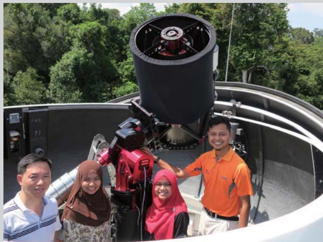
馬來西亞浮羅交怡國家天文台 0.5 米口徑望遠鏡 0.5m aperture telescope for Langkawi National Observatory, Malaysia
