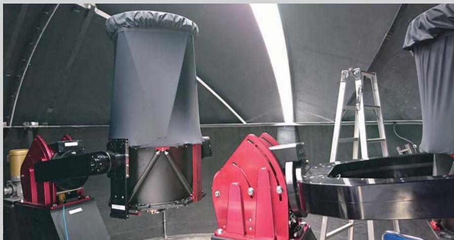
印尼國家航天研究所 (LAPAN) 天文圓頂及兩台 0.5 米口徑望遠鏡 Observatory dome with two 0.5 meter telescopes for Indonesia Space agency (LAPAN)
