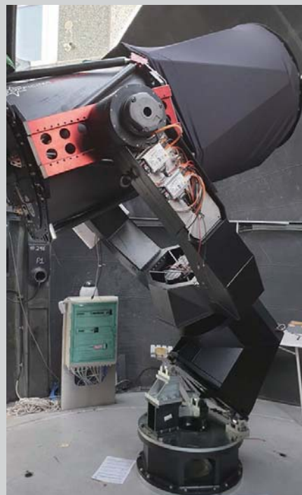
印尼蘇門答臘理工學院 0.7 米 RC 望遠鏡廠內測試 Factory testing the 0.7m aperture telescope for Sumatera Institute of Technology, Indonesia
