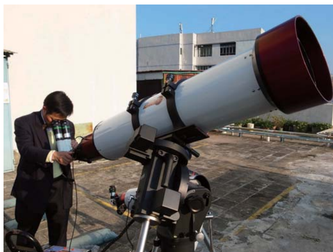
供應韓國用戶 23 公分口徑 Ha 光譜太陽望遠鏡 23cm aperture solar telescope for Korean user
