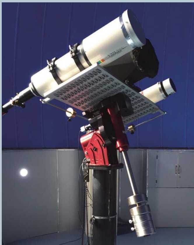
為深圳西涌天文台開發的自動化平台 Automation platform developed for ShenZhen XiChong Observatory
