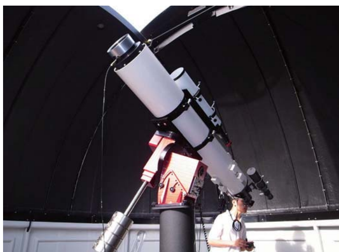
保良局顏寶鈴書院太陽觀測用全球最大 16 公分振腔濾鏡 16cm clear aperture, the world's largest etalon for solar observation, of PLK Ngan Po Ling College (as of 2010)
