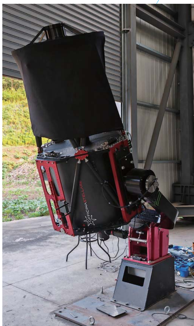
紫金山天文台 0.7 米口徑 RC 望遠鏡 0.7m aperture RC telescope for Purple Mountain Observatory
