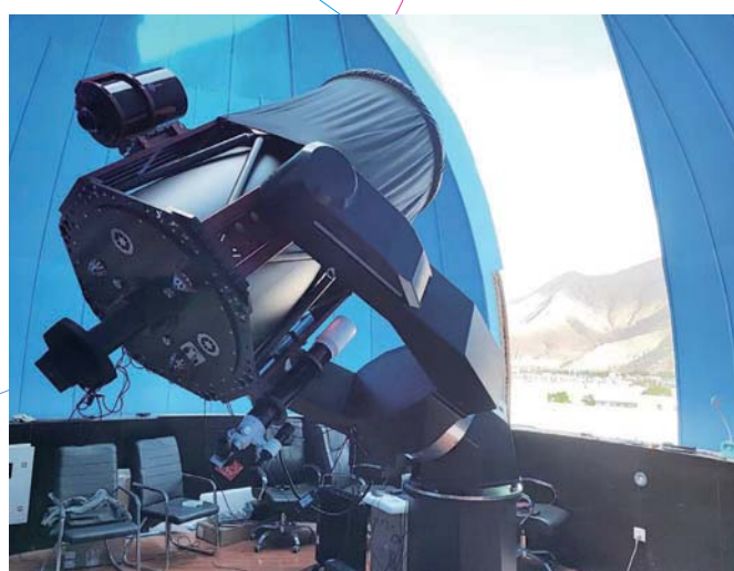
西藏大學 0.8 米口徑 RC 望遠鏡 0.8m aperture RC telescope for Tibet University
