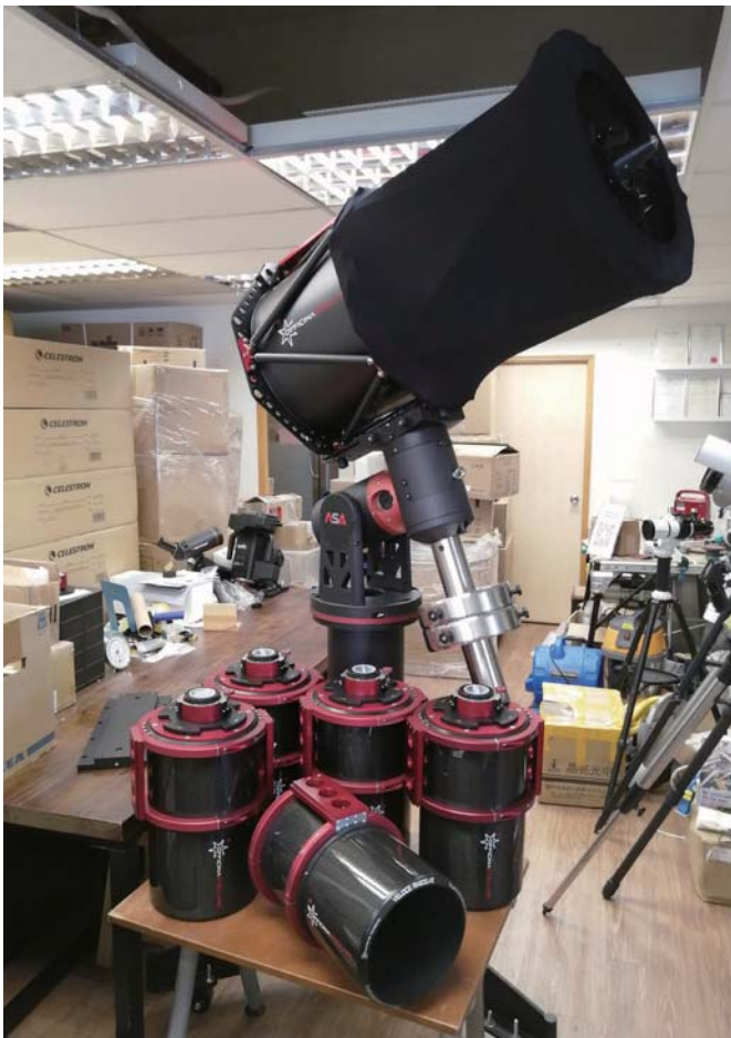
中山大學 0.4 米口徑 RC 望遠鏡及 0.2 米口徑 RH 攝星儀 0.4m aperture RC telescope & 0.2m aperture RH astrographs for Sun Yat-sen University
