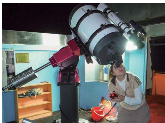
香港西貢白普里營天文台自動化赤道儀 Automated equatorial mount in Bradbury camp Sai Kung
