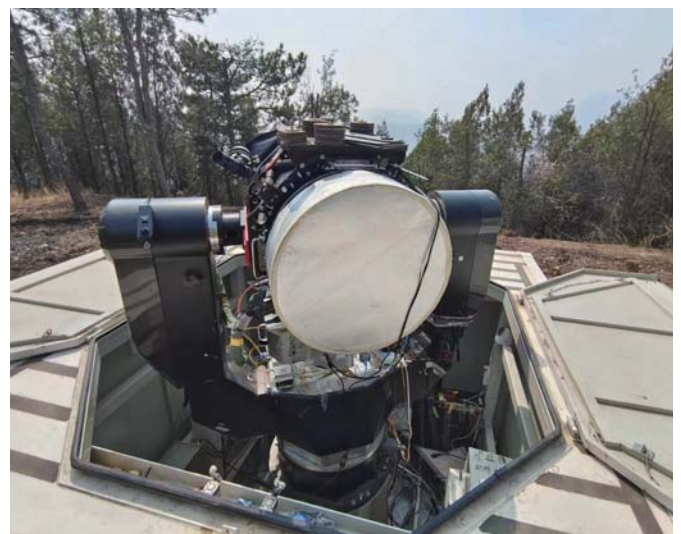
中國科學院 0.5 米口徑通訊望遠鏡 0.5m aperture communication telescope for Chinese Academy of Sciences
